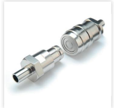
Im gekuppelten Zustand ist die Sterilkupplung nach außen geschlossen. Beim Auskuppeln ist es wichtig, dass die freiliegenden stirnseitigen Ventilflächen vom Bediener nicht berührt werden. Ein Reinigen dieser Flächen beispielsweise mit Ethanol und kurzer Trockenpause vor dem erneuten Einkuppeln bietet zusätzliche Sicherheit. Zur Unterstützung kann die Kupplung mit Berührungsschutz und Schutzkappen ausgerüstet werden.
