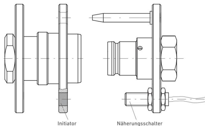
Mit Ronden und elektronischem Identifikationssystem
